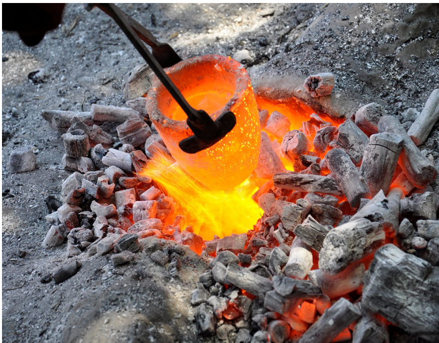
Fig.10. Crogiolo in grafite utilizzato nella fossa B con metallo pronto per la colatura in matrice. Graphite crucible used in pit B with metal ready to poured in the mould.
