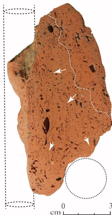
Fig. 20. Castello di Annone (AT), riorganizzazione e deformazione della porosità (vuoti residuali di vegetali e vacuoli schiacciati) in base alla direzione del gesto esercitato durante la messa in opera e alla presenza di elementi lignei su cui l'impasto viene applicato (foto archivio SABAP-TO).
