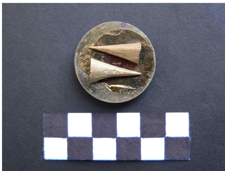
Fig. 55. Calchi metallizzati per il SEM.
