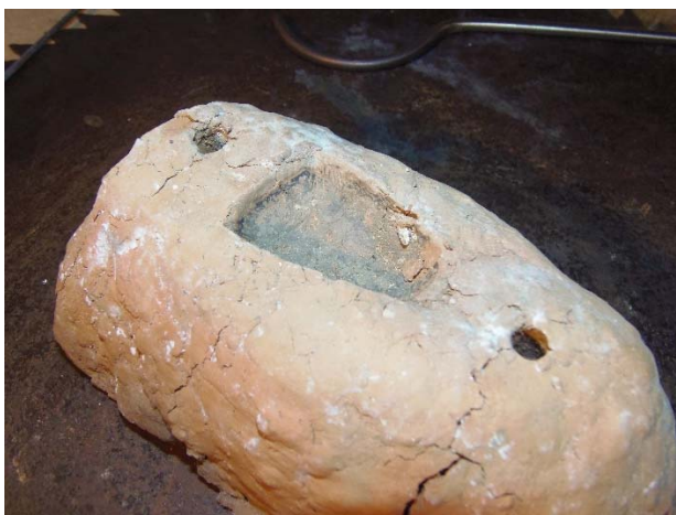
Fig. 14 a-b. Alterazione della matrice MF1 dopo la prima e la quinta fusione di lingottini. Alteration of the MF2 mould after the first and fifth ingot casting.
