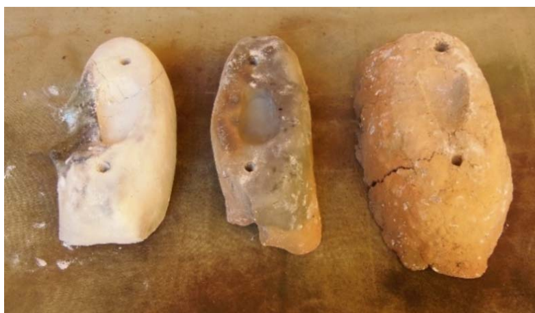
Fig. 10 a-b. La frattura prodottasi nella matrice MF2 in fase di cottura. The fracture produced in the MF2 mould during firing.
