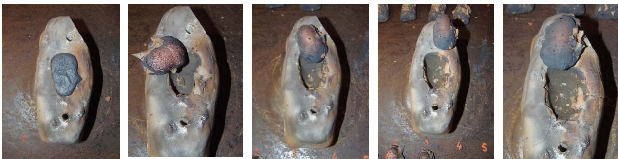
Fig. 16 a-e. La forma di fusione MF2 e i cinque lingottini ottenuti. MF2 mould with respective ingots.
