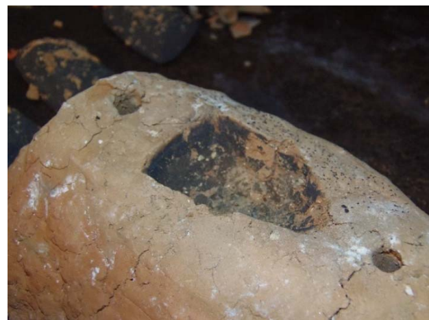
Fig. 14 a-b. Alterazione della matrice MF1 dopo la prima e la quinta fusione di lingottini. Alteration of the MF2 mould after the first and fifth ingot casting.
