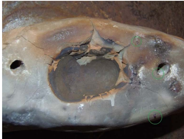
Fig. 12. Sferule di rame presenti sulla matrice MF2 a fine fusione. Copper droplets on the MF2 mould at the end of the casting.
