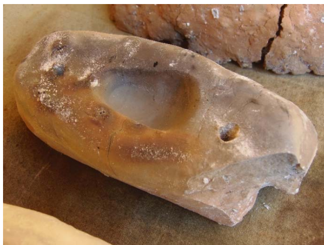
Fig. 10 a-b. La frattura prodottasi nella matrice MF2 in fase di cottura. The fracture produced in the MF2 mould during firing.
