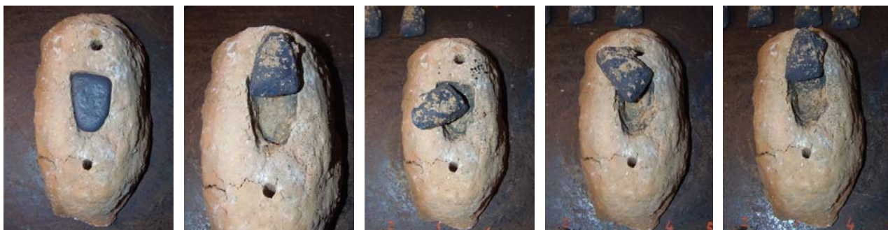
Fig. 15 a-e. La forma di fusione MF1 e i cinque lingottini ottenuti. MF1 mould with respective ingots.
