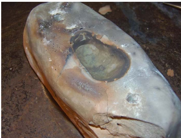
Fig. 13 a-b. Alterazione della matrice MF2 dopo la prima e la seconda fusione di lingottini. Alteration of the MF2 mould after the first and second ingot casting.
