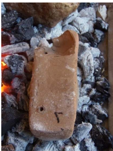
Fig. 10 a-b. La frattura prodottasi nella matrice MF2 in fase di cottura. The fracture produced in the MF2 mould during firing.
