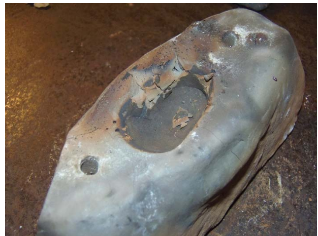
Fig. 13 a-b. Alterazione della matrice MF2 dopo la prima e la seconda fusione di lingottini. Alteration of the MF2 mould after the first and second ingot casting.
