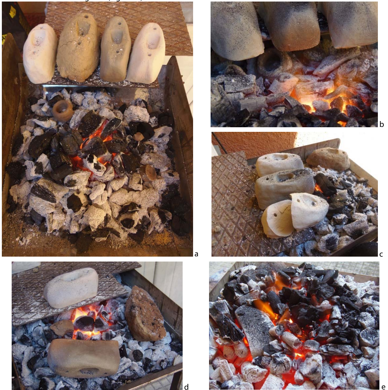
Fig. 9 a-e. Le varie fasi del processo di cottura delle forme di fusione. The various stages of the firing process of the moulds.
