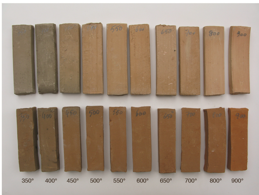
Fig.10 Campioni di argilla cotta. Intervallo di temperatura tra 350°C e 900°C. Clay test plates after firing. Temperature range between 350°C and 900°C.
