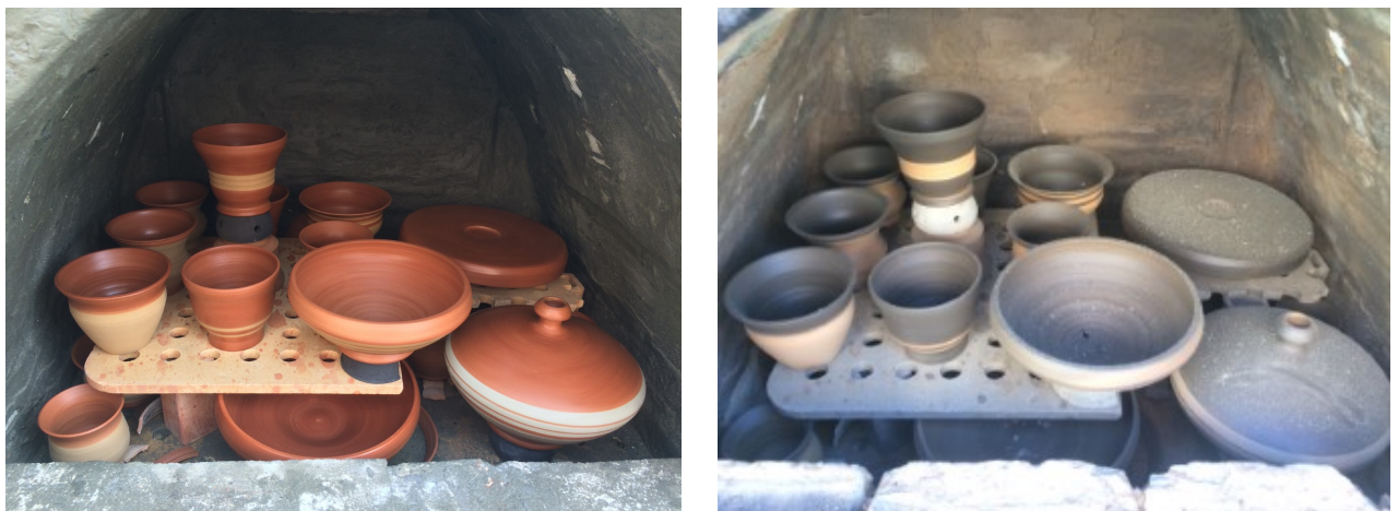
Fig.7. A sinistra riproduzioni crude dipinte dopo l'impilaggio nella camera di cottura e a destra il risultato post cottura in semi riduzione finale dopo il raffreddamento e l'apertura del portellone di carico della fornace. On the left painted replicas before the firing in the upper chamber of the kiln, on the right the pottery after the firing and cooling down for opening the furnace's door.
