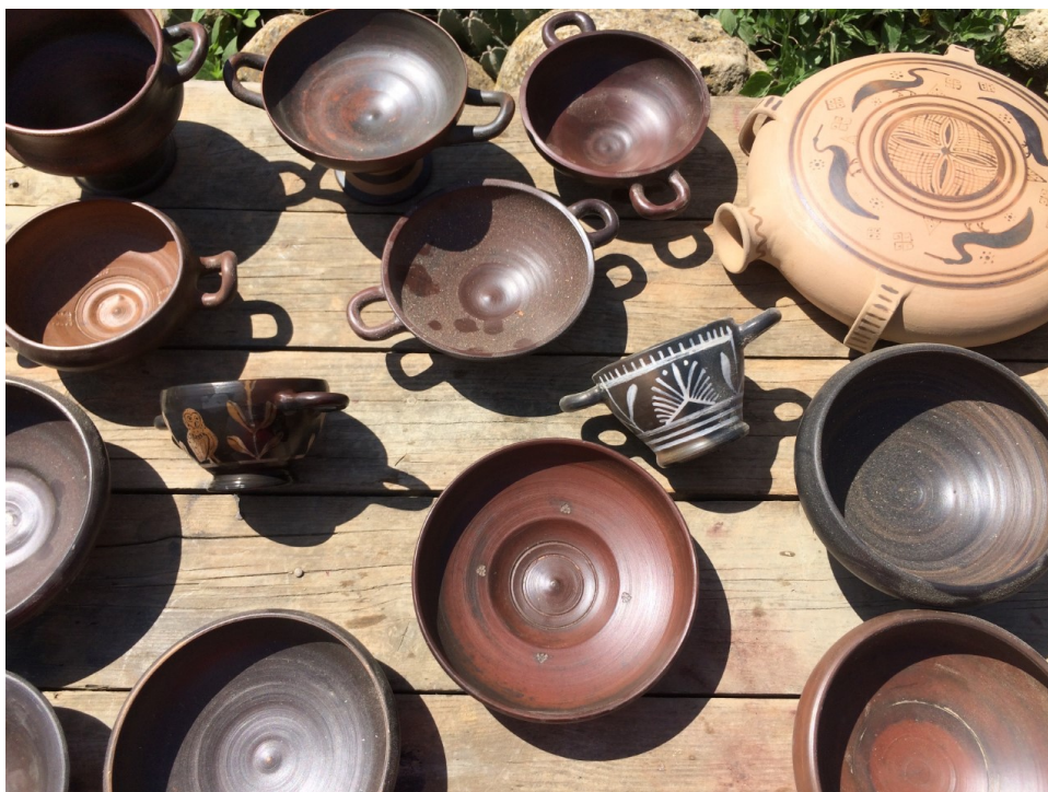
Fig.8. Produzione di ceramiche a vernice nera con difetti dovuti a bassa temperatura e al posizionamento non idoneo all'interno della fornace. Butch of black glazed pottery with imperfections due to low temperature and incorrect positioning inside the kiln.
