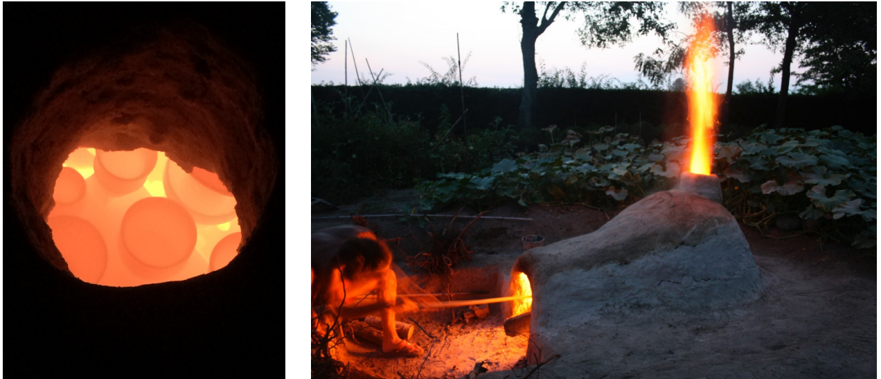
Fig.6. Immagini del processo di cottura dei vasi a vernice nera. A sinistra, vasi incandescenti nella camera di cottura visti dal camino. A destra, la fornace durante il raggiungimento dell'alta temperatura prima della riduzione. Detail views of the firing process of black glazed pottery. Left, heated vessels seen from the chimney. Right, the kiln during the heating phase, before the process of reduction.
