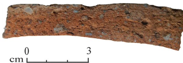
Fig.29. Mursia. Capanna B12. Sezione polita per analisi macroscopica di stesura di piastra in terra. La superficie inferiore reca l'impronta concava di un elemento costitutivo del vespaio della piastra (da PEINETTI 2016, fig.26). Mursia, B12 hut. Polished section for macroscopic analysis of cooking plaster (from PEINETTI 2016, fig.26).
